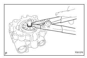
(d) Using a snap ring expander, install a new snap ring onto the pulley shaft.
